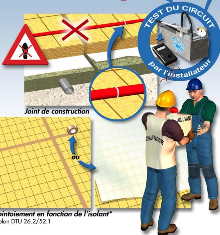
Jointoiement en fonction de l'isolant\*
