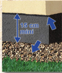
Pied de mur
